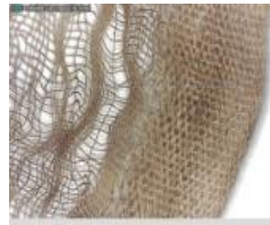
Foto11 b - «Laləli» ipək qaz parçanın toxunuş strukturunun mikroskopla fotosəkili
