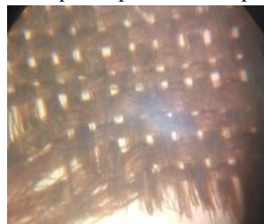
Foto 3 - İpək parçanın toxunuş strukturunun mikroskopla fotosəklili
