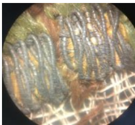
Foto11 c - «Laləli» ipək qaz parçanın güləbatın saplarının mikroskopla fotosəkili.
